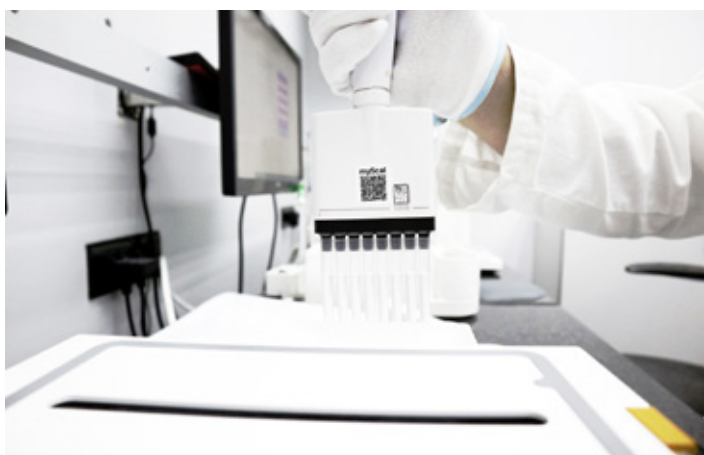
Slika 1. Korištenje 8-kanalne pipete u kombinaciji sa Speedcal mobile i myScal® programskim rješenjem smanjuje vrijeme umjeravanja na 15 minuta.
