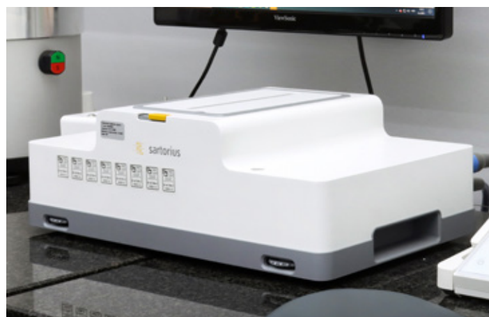
Slika 2. SpeedCal mobile vaga dostupna je s 4, 8 ili 12 kanala, uz mogućnost naknadnog proširenja do 12 kanala.
